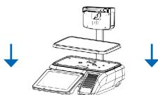
Para verificar se a balança está corretamente nivelada, verifique o nível bolha localizado abaixo do prato de pesagem da balança. Sendo necessária alguma correção, ajuste os pés reguláveis da balança.
