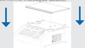
Para verificar se a balança está corretamente nivelada, utilize um nível do tipo carpinteiro sobre o prato de pesagem da balança.
