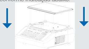
Para verificar se a balança está corretamente nivelada, utilize um nível do tipo carpinteiro sobre o prato de pesagem da balança.
