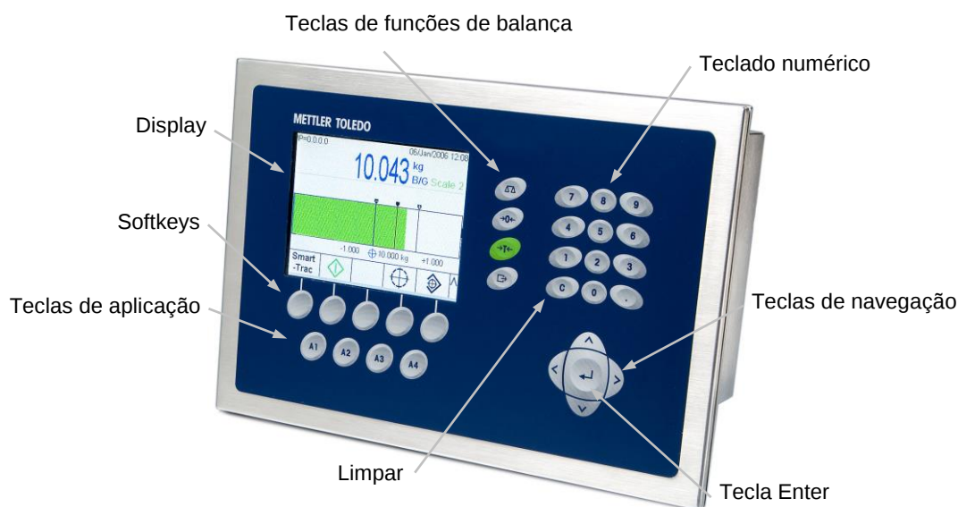
Figura 1-4: disposição do painel frontal
