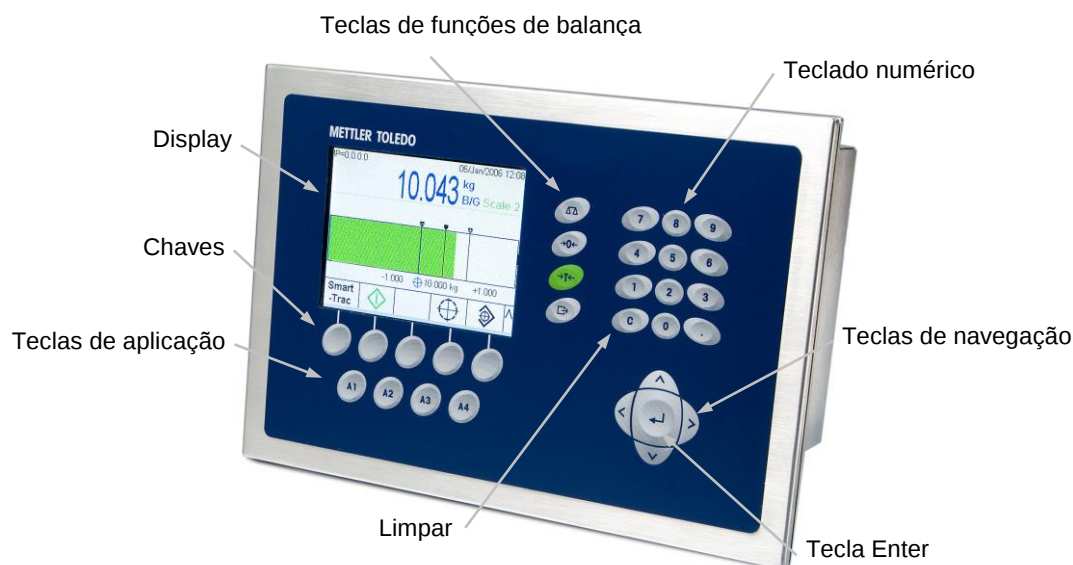
Figura 3-1: Componentes do painel frontal e localização das teclas
